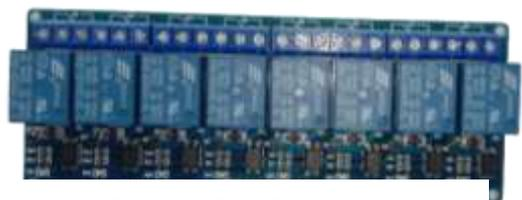
Pada *Project* yang dipergunakan adalah *Relay 8 Channel*, pada modul *Relay* ini sudah menggunakan komponen *optocoupler* yang mana digunakan untuk mencegah arus bocor dari kontrol tegangan yang sedang di kontrol. Selain itu pada modul ini juga sudah dilengkapi dengan Transistor penstabil tegangan yang mana tegangan kerja pada modul ini adalah 5V.
