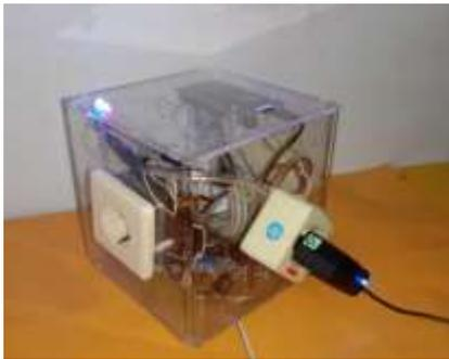
Gambar 18. Stopkontak ON saat Switch Tertekan
