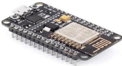
**Gambar 1.** Mikrokontroler Nodemcu ESP8266
