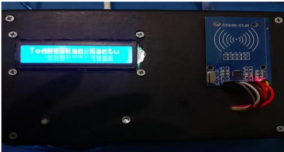
**Gambar 9.** Perangkat Keras Alat Sistem Absensi Berbasis Website
