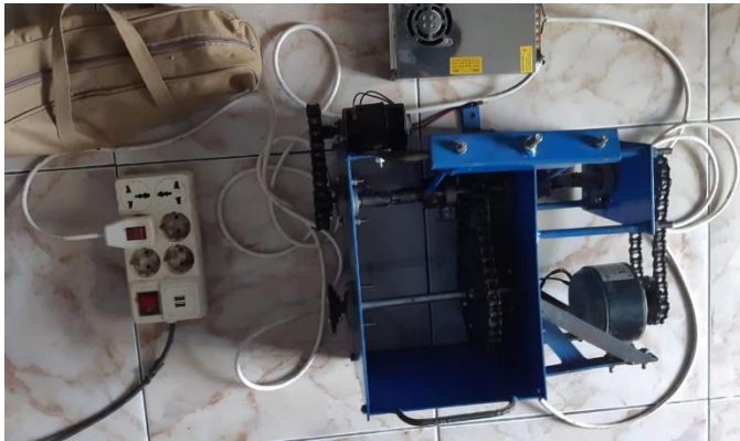
Gambar 14. Sistem Sirkuit Transmisi Penggerak Roda Gigi Mesin Pertama dan Kedua
