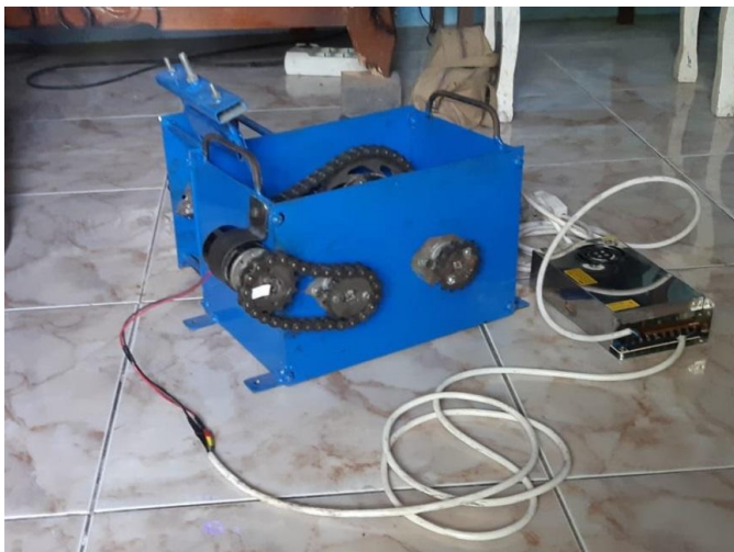
Gambar 11. Roda Gigi Dihubungkan Ke Mesin 2 Motor Listrik Dengan Daya 200 Watt
