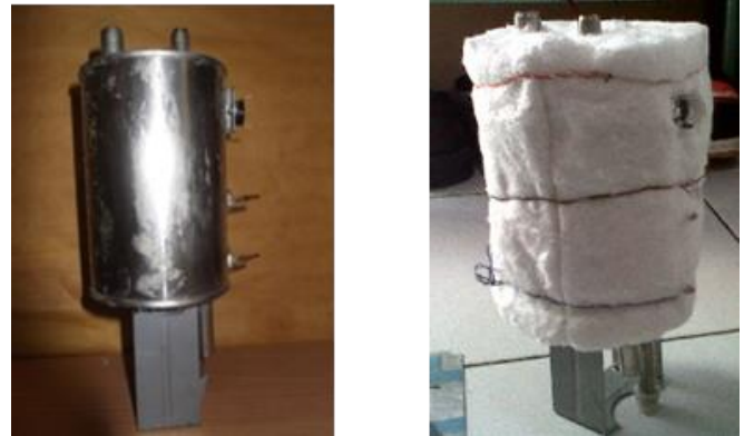
Gambar 4 Tabung air panas sebelum modifikasi dan sesudah modifikasi dengan tebal glass wool 8 mm, 15 mm, dan 23 mm
