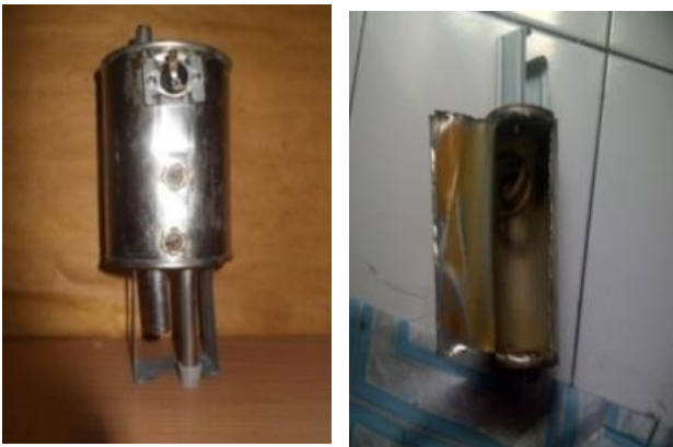
Gambar 3. Tabung air panas dispenser air dan komponen bagian dalam tabung pemanas
