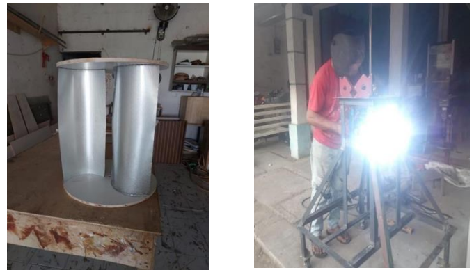
Gambar 5. Pembuatan Sudu dan Pengelasan Frame
