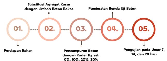
Gambar 1. Diagram alir prosedur eksperimen beton daur ulang dengan fly ash
